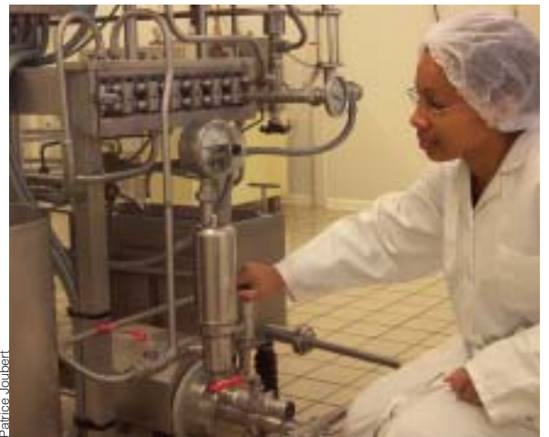
Conduite d'un pasteurisateur.
